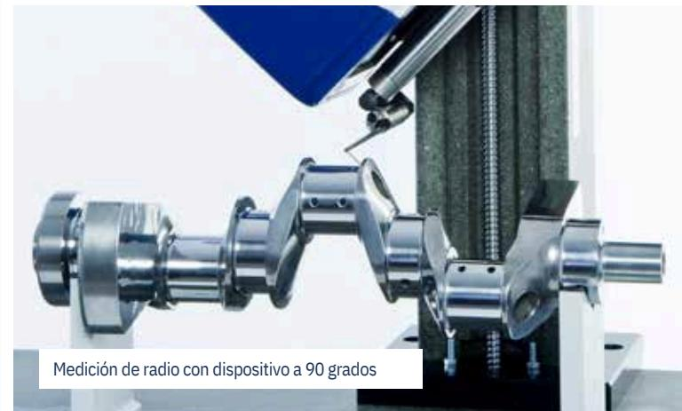
Medición de radio con dispositivo a 90 grados
