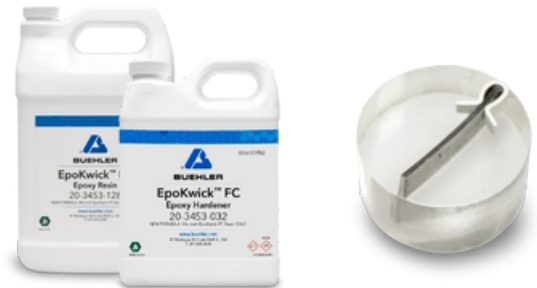
Figura 2: El epoxi EpoKwickFC brinda excelente retención de bordes, baja contracción y baja viscosidad. Esto aseguró que no hubiera delaminación del tablero debido a la preparación de la muestra durante los pasos de esmerilado y pulido.
