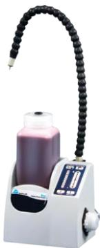
Se puede utilizar un módulo de spray con el interruptor manual para controlar la dosificación en sistemas EcoMet 30. Configure la velocidad de dosificación en el módulo de spray y use el interruptor manual para iniciar y detener la dosificación.
